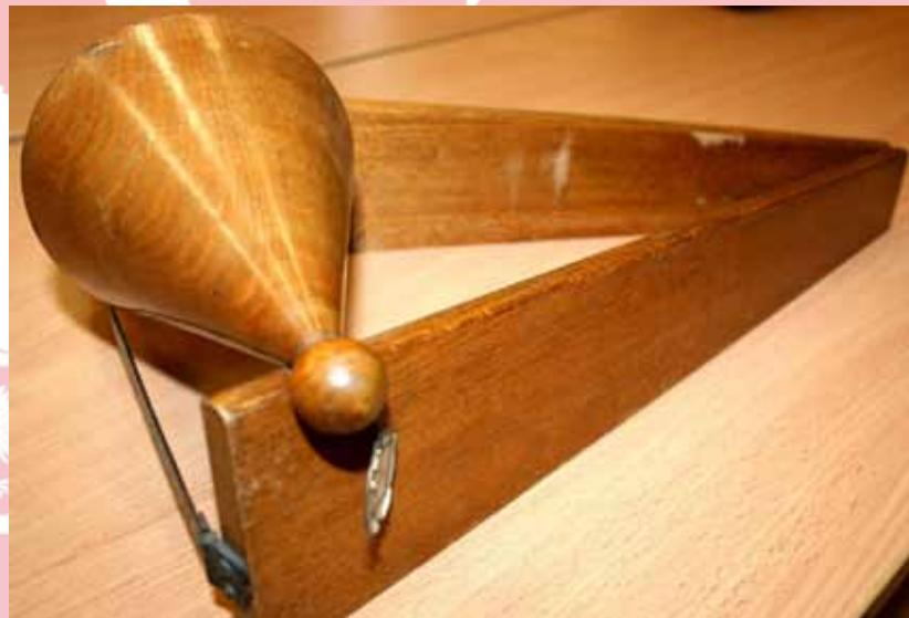
A két, felfelé szélesedő fadeszkából készített ék alakú lejtőn a ráhelyezett kettős kúp a deszkák szélesebb vége felé gördül. A lejtő alakjából következően a kettős kúp tehát a lejtőn nem „lefelé”, hanem „felfelé” mozog.
