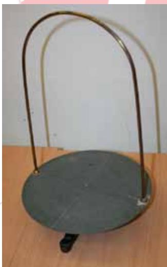
A Gimnázium fizika szertárában található golyováz hiányos, eredetileg a XIX. század végéről illetve a XX. század elejéről származhat. Talapzata vasból, a váz rézből készült, a forgó korong anyaga valamelyen ötvözöt. Eredetileg egy fonál, illetve egy ólomgolyócska, esetleg egy tintatartóval is ellátott nehezék is tartozhatott hozzá.
