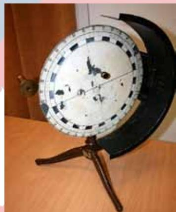
A Hartl-korong - a fénytörés és a fényvisszaverődés törvényeinek igazolásán túl- a lencsék, a tükrök és a prizmák nevezetes sugármeneteinek szemléltetésére is kiválóan alkalmas. Emiatt a taneszköz gyártó cégek a korai Hartl-korongokat a szorítócsavarokhoz odafogható gyűjtőlencse, szórólencse, planparalel, prizma, kör és félkör alakú üvegtest mellékletekkel látták el.
