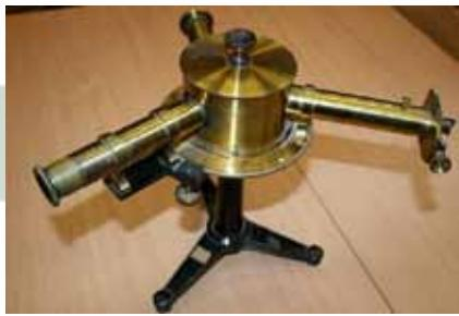
A spektroszkópok a színképek (spektrumok) tanulmányozására szolgáló készülékek. A JAG-ban található eszköz a XX. század első éveiben kerülhetett a szertárba. A jelenleg is működő, többek között optikai berendezéseket is gyártó hamburgi Krüss cég terméke. Főbb részei rézből, lábai vasból készültek.
