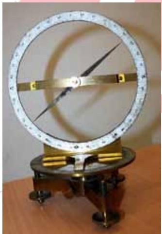
A JAG fizika szertárában található inklinatórium egy olyan mágnesűrű, amely a súlypontján átmenő vízszintes tengely körül - egy függőleges síkban elhelyezett, szögbeosztással ellátott skála mentén- foroghat. Talpazata fából, állítható magasságú „lábai”, a váza és a többi része (a mágnesűrű kívül természetesen) rézből készültek. A 10. évfolyam fizika oktatását segíti, a Föld mágneses terének tulajdonságait, pontosabban az inklináció jelenségét lehet demonstrálni vele.
