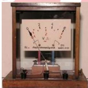
A JAG fizika szertárában a 20. század második feléből számos elektromos feszültség illetve elektromos áram mérésére használt tanári demonstrációs műszer található. A bal oldali képen egy olyan műszer látható, amely az 1950-es évek végétől az 1970-es évek elejéig volt a fizika és a technika órák kedvelt tanári demonstrációs eszköze. Az eszközök a sönt és
