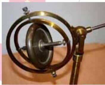
Az eszközt az ún. precesszió jelenségének bemutatására szokás felhasználni. A szimmetriatengelye körül gyors forgásba hozott és ferdén az állványra tett súlyos pörgettyű nem billen le, hanem a szimmetriatengely a rá ható erő irányára merőlegesen tér ki és függőleges tengelyű körkúp palástja mentén mozog, ezt a mozgást nevezük precessziónak.
