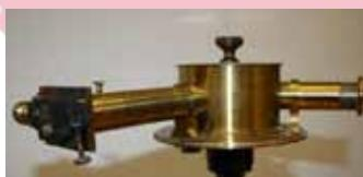
A spektroszkóp leglényegesebb része egy sárgaréz tartóra erősített üvegprizma, melynek egyik törőlapjára a megvizsgálandó fény sugarai az A cső, az ún. kollimátorcső végén levő, mérőcsavarral szabályozható szélességű résen át érkeznek. A kollimátorcső a nevét onnan kapta, hogy a cső egy gyűjtőlencsét tartalmaz, amely párhuzamosakká teszi a fénysugarakat, s így a prizmát már párhuzamos sugarak fogják elérni.
